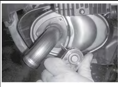
TÍPICO - RETIRE EL TUBO DE ESCAPE.
