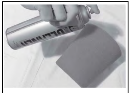
TÍPICO - ROCÍE EL FILTRO DE ESPUMA.
