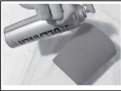
CONFIGURAZIONE TIPICA - SPRUZZARE L'ELEMENTO IN MATERIALE ESPANSO
