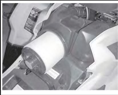
EXTRACCIÓN DEL FILTRO DE AIRE
