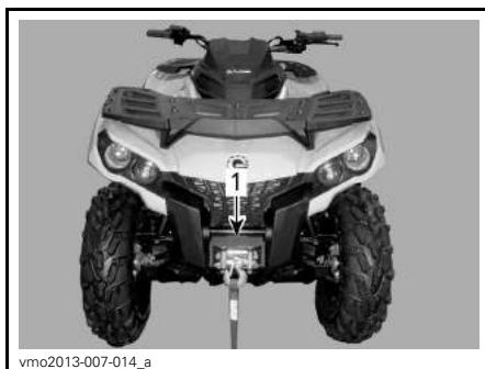
1. Emplacement du point d'arrimage avant
