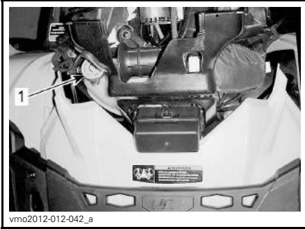
1. Réservoir de liquide de refroidissement
