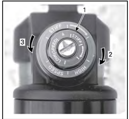
COMPRESSIEDEMPING BIJ HOGE SNELHEID (GEBRUIK EEN SLEUTEL VAN 17 MM)
