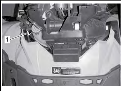
1. Depósito de refrigerante del motor
