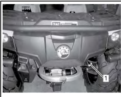
1. Tapa del compartimiento de almacenamiento trasero
