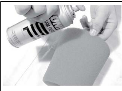
TYPISCH - SCHAUMSTOFFFILTER ÖLEN
