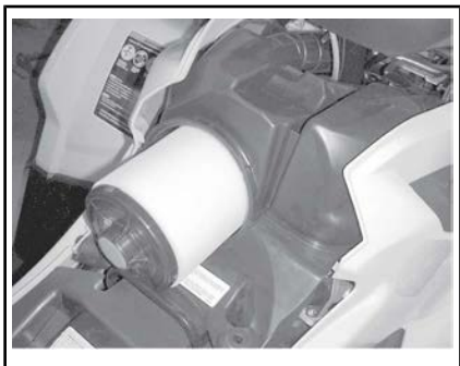
空气滤清器拆卸
