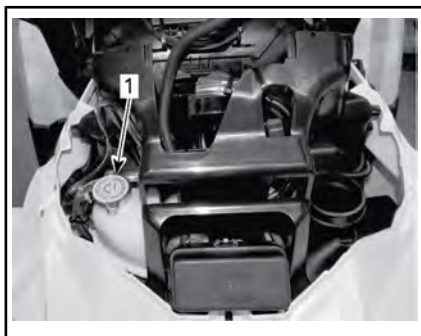
1. Tappo del serbatoio liquido refrigerante motore
