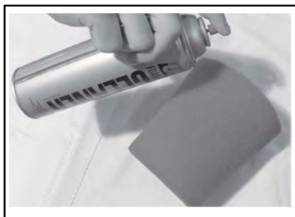
TÍPICO - BORRIFE NO ELEMENTO DE ESPUMA DO FILTRO
