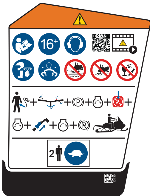
始動手順 - 警告ラベル
