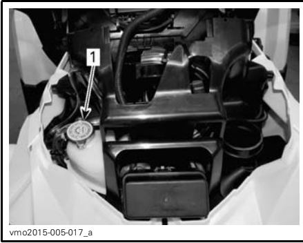
1. Réservoir de liquide de refroidissement
