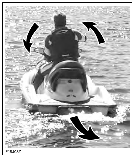
典型示例 - 后退时转向方向相反
