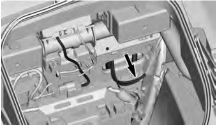
DC12 - 前客户配件电路 - 储物舱后方 2. 横向检修盖后方。
