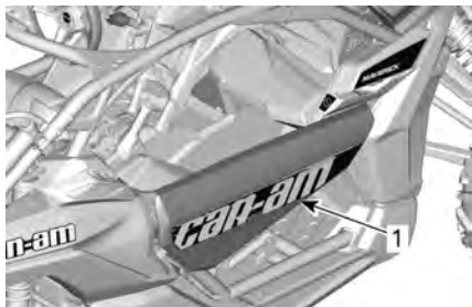
1. Porta fechada e corretamente travada
