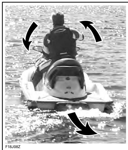
典型示例 - 后退时转向方向相反
