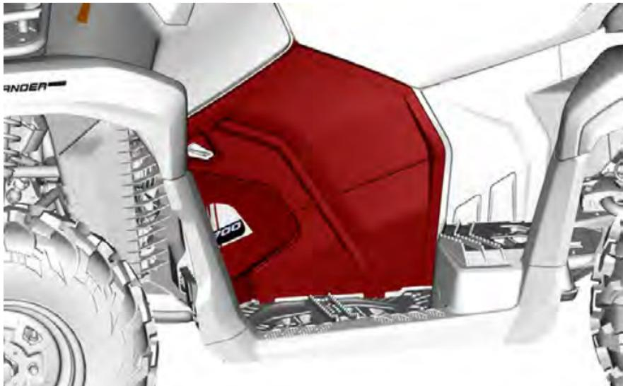
2. Remova o para-lama interno dianteiro esquerdo.
