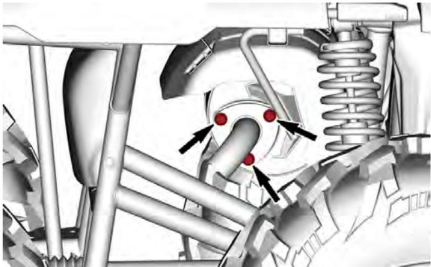
2. Remova o tubo de saída do escapamento e descarte a gaxeta.
