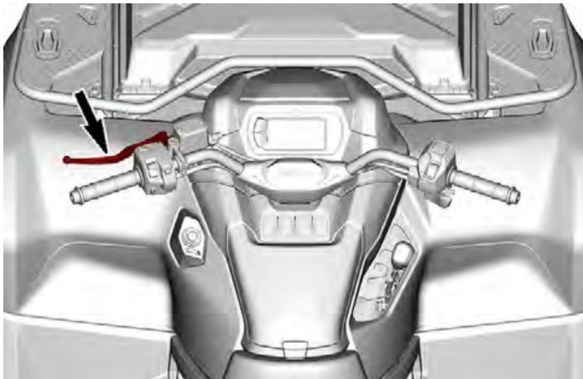
A função da alavanca do freio é reduzir a velocidade ou parar o veículo.
