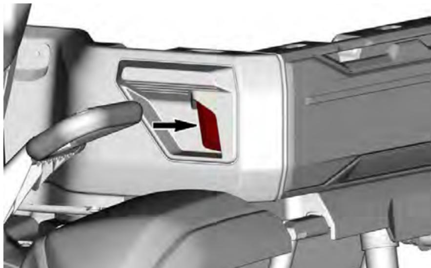
4. Enquanto segura a alça dianteira, move a parede para trás até que o gancho de retenção dianteiro esteja visível.
