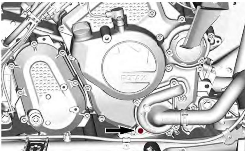
3. Para finalizar o esvaziamento completo do sistema de arrefecimento, desconecte a mangueira inferior do radiador da tampa da bomba de água e drene o líquido de arrefecimento restante em um recipiente apropriado.
