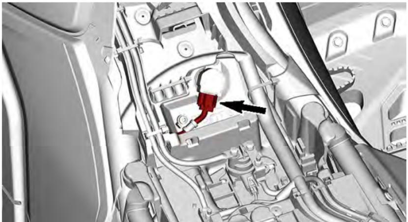
3. Retire a bobina de ignição.
