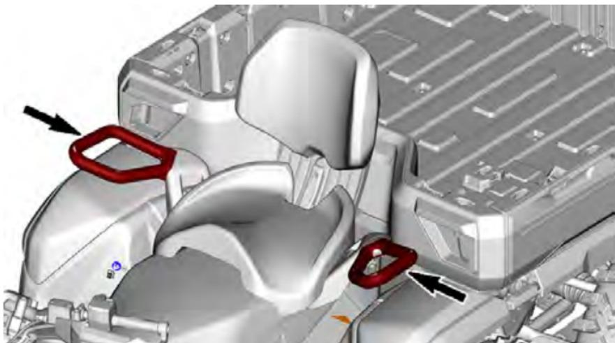
Elas devem ser usadas pelo passageiro para se segurar com firmeza durante a operação do veículo.
