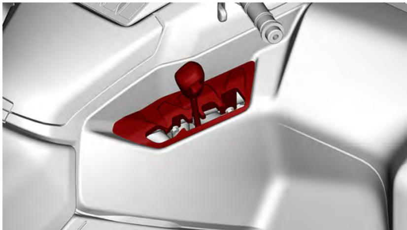
Esta alavanca é usada para trocar a posição da caixa de câmbio.
