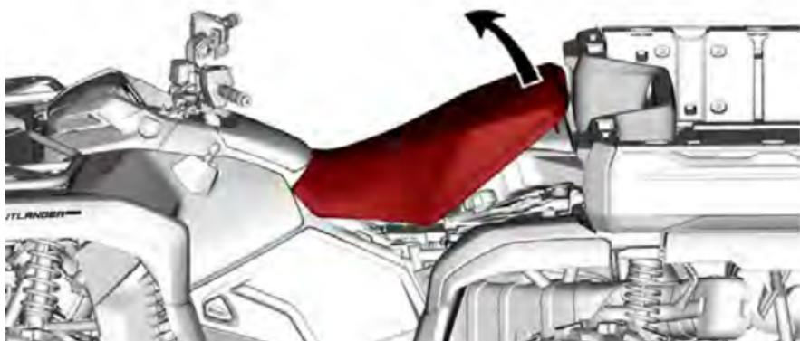
3. Continue levantando-o até que você possa soltar a aba de encaixe dianteira, e depois remova o assento totalmente.
