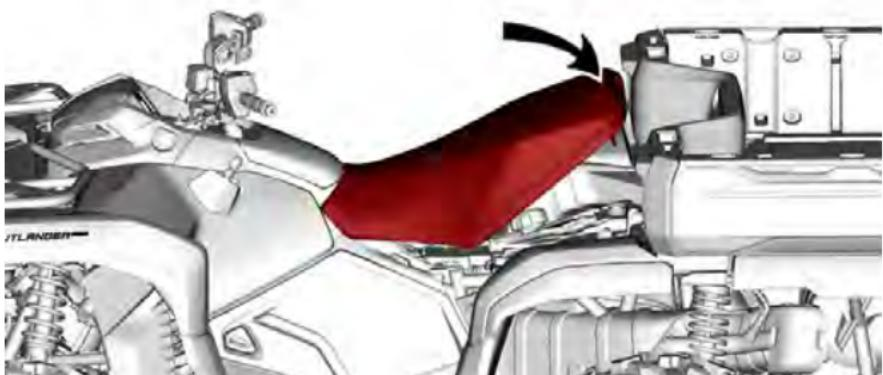
4. Verifique de novo se o assento está instalado firmemente, puxando com força a parte dianteira para confirmar que está devidamente travado.
