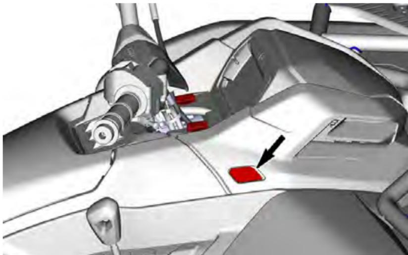
3. Desencaixe as duas abas de travamento nas laterais da direção.
