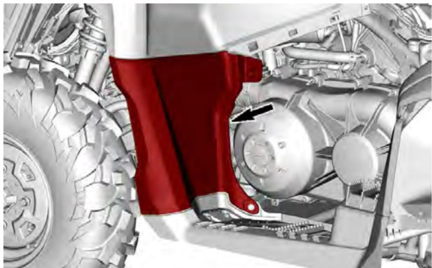
4. Desconecte o duto de refrigeração do ar de entrada da tampa da CVT.
