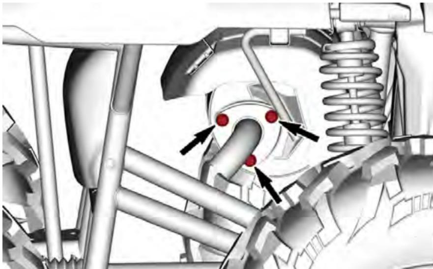
2. Remova o tubo de saída do escapamento e descarte a gaxeta.
