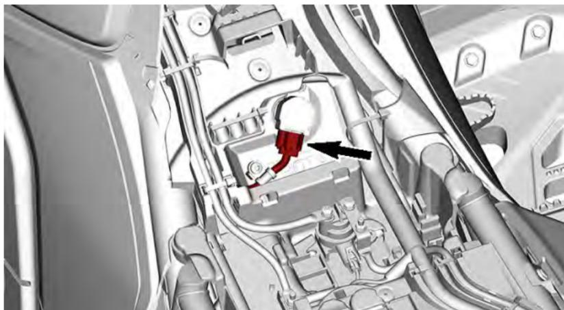
3. Retire a bobina de ignição.
