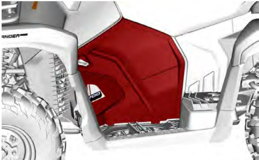
2. Remova o para-lama interno dianteiro esquerdo.
