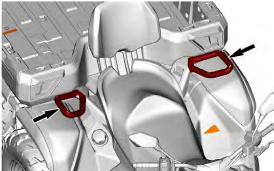
Elas devem ser usadas pelo passageiro para se segurar com firmeza durante a operação do veículo.
