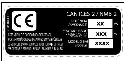
LOCALIZAÇÃO: SOB O ASSENTO, NO MEMBRO DA ESTRUTURA SUPERIOR
