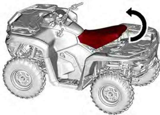
4. 继续向上移动，直到可以松开前固定装置，然后完全拆下座椅。
