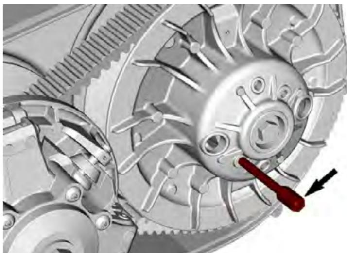
4. 转动从动皮带盘，直至驱动皮带外表面上的轮齿最低部分与从动皮带盘的边缘齐平。
