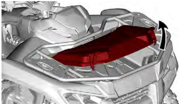
2. 转动位于储物箱内的锁杆，将盖锁定在打开位置。
