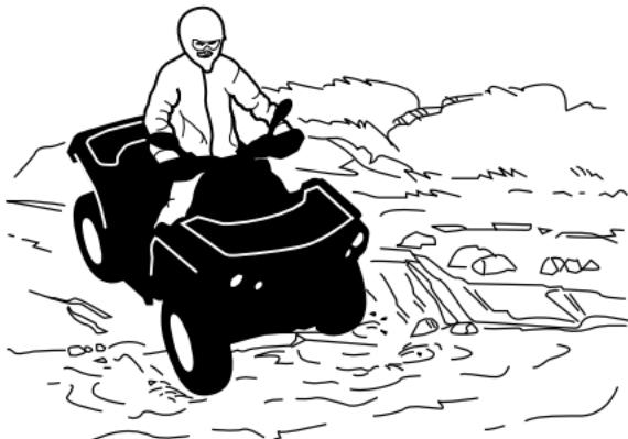
制动器进水会影响车辆的制动能力。车辆离开水域、泥地或雪地之后，确保应用制动器数次以使其干燥。留出更大的制动距离。
