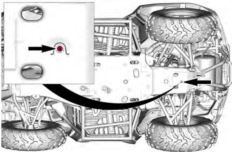
4. 将泄油盘放在后主减速器下方。
