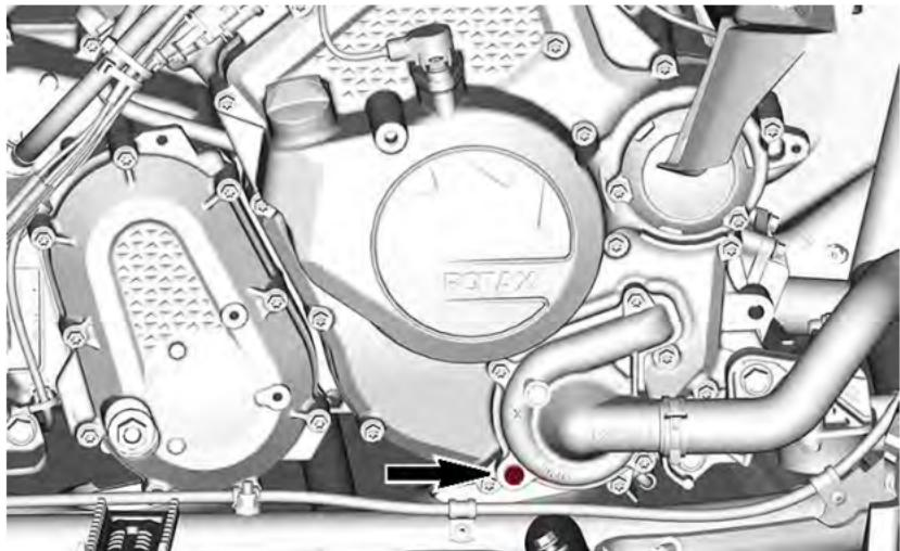
3. 为了完成冷却系统的完全排空，请断开水泵盖上的下散热器软管连接，将剩余冷却液排入合适的容器。
