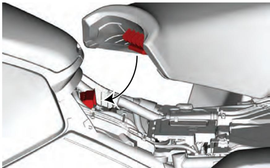
2. 推压座位后部以将其正确定位。
