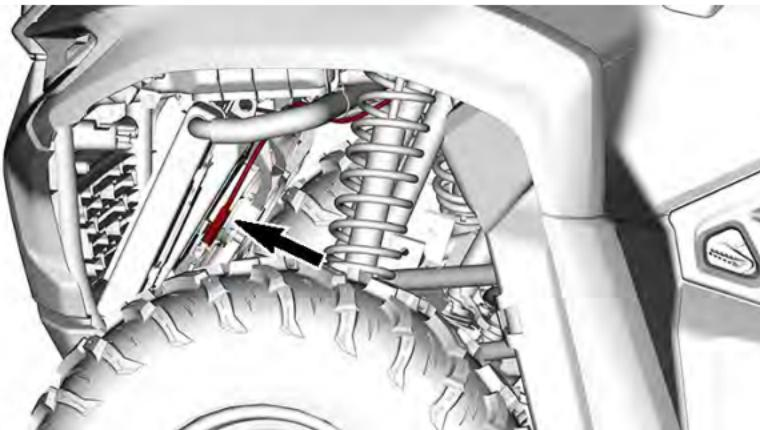
3. 将散热器风扇向车辆拉动
