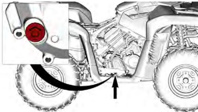
5. 检查油位。机油液位应当处于机油液位孔的底部。
