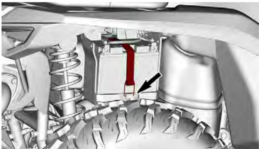
3. 先连接蓄电池的红色 (+) 导线，然后再连接蓄电池的黑色 (-) 导线。
