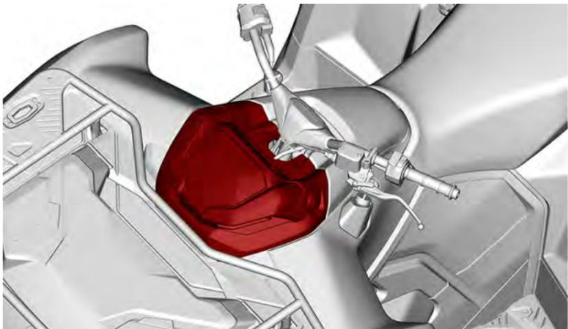
3. 液位应处在冷却液储液罐的 MIN. ( 最低 ) 和 MAX. ( 最高 ) 标记之间。
