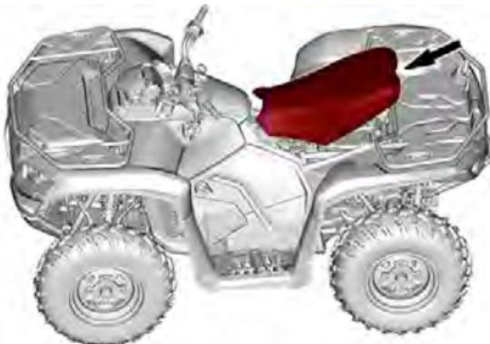
3. 当座椅就位后，用力将座椅向下推至锁止位置。将感到明显的卡入感。
