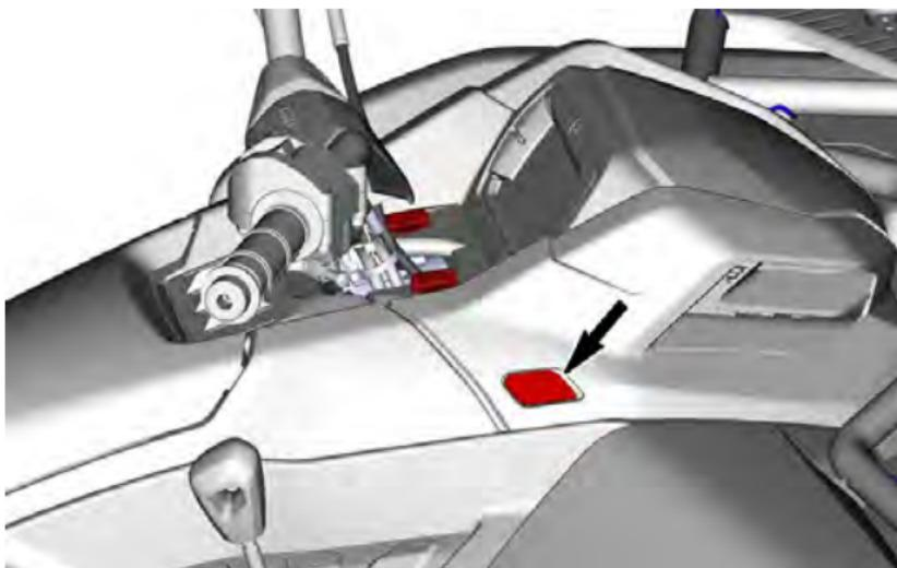
4. 旋转两 (2) 个四分之一圈以固定控制台。
