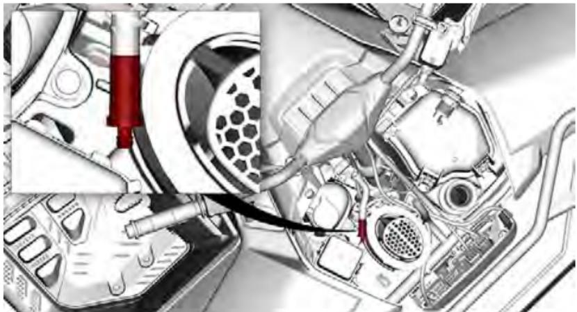
1. 在控制台右侧，从滤清器上拔下软管。
