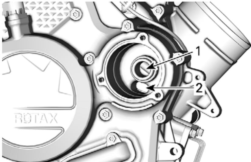
1. 至发动机机油供给系统的出口孔
