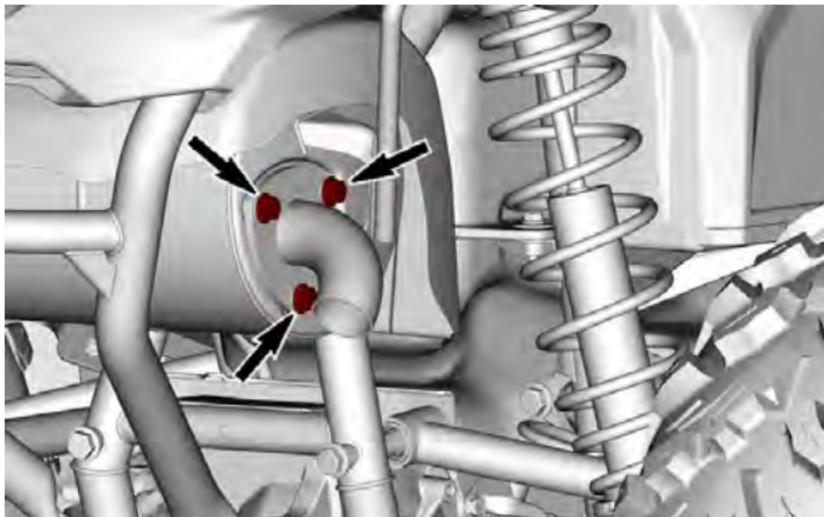
2. 拆下带进口阻火器的排气尾管和垫片（将其丢弃）。
