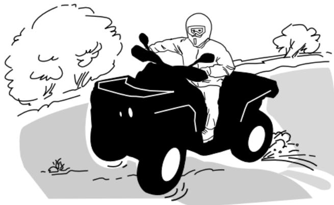
如果您确实出现打滑或滑行，在您重新控制住车辆之前，向滑行的方向转动手把可能会有帮助。请勿堵住制动器并将车刹住。
