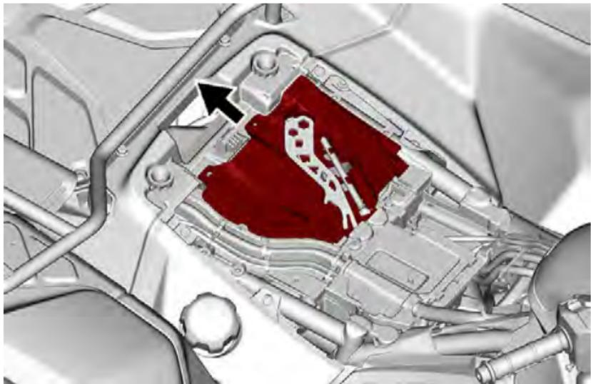
4. 切断将滤清器固定在其底座上的扎带。
