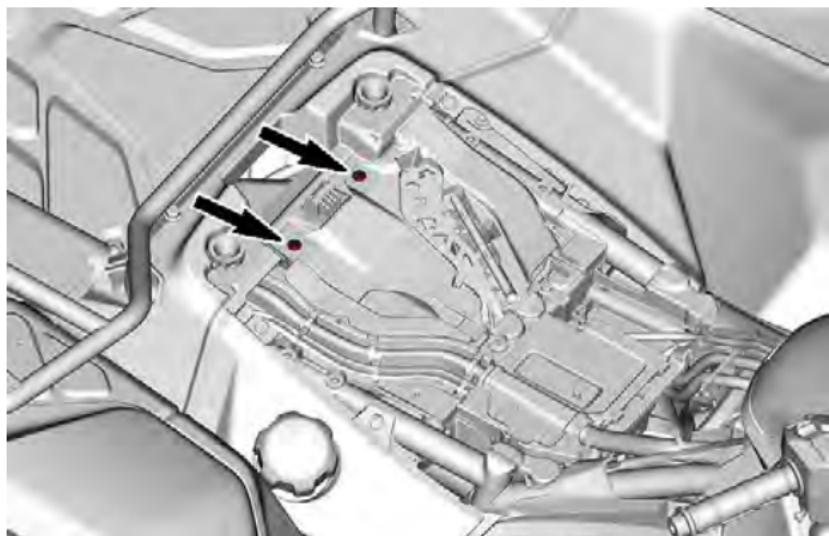
3. 拆下燃油泵检修板。
