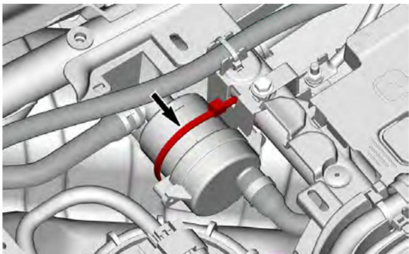
5. 拆下用于将软管固定在滤清器上的卡箍。丢弃 Oetiker 卡箍。
