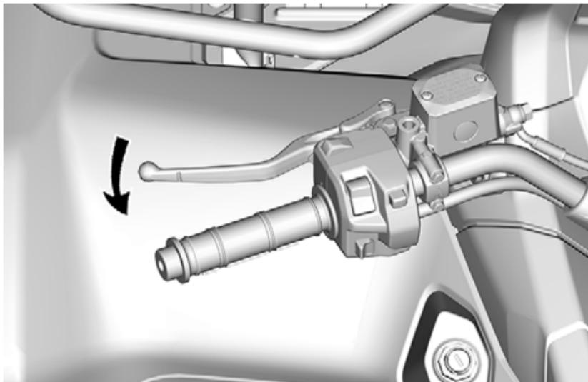
制动效果与施加于制动杆上的力成正比。
