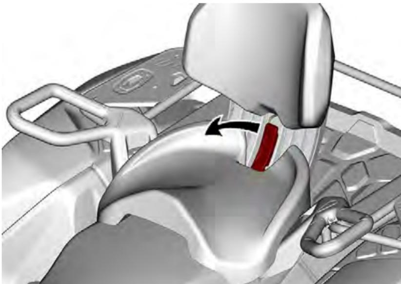
2. 在保持闩锁杆向前拉动的同时，在闩锁杆的背面施加向下的压力，以使后闩锁脱离销，并使用靠背将座椅向前拨动。
