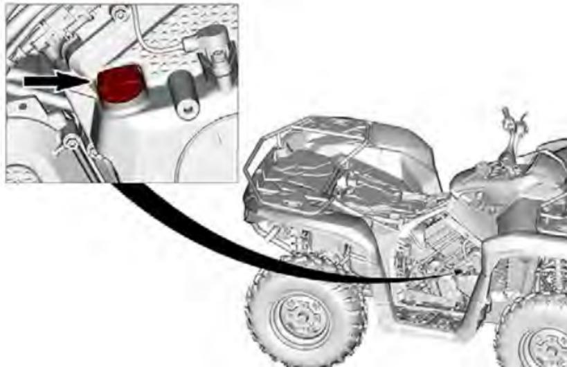
7. 旋松机油尺，然后将其拆下并擦干净。
