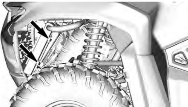
2. 断开散热器风扇接头。
