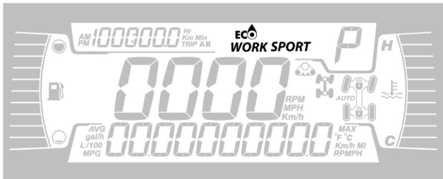
发动机模式显示可显示选定的操作模式：
