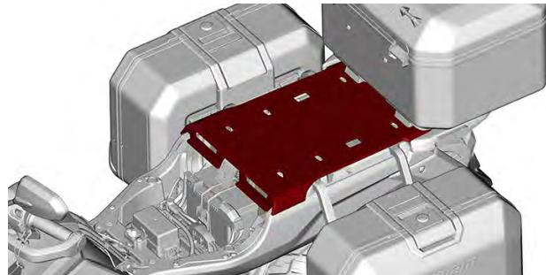
2. Installare in posizione il sedile del passeggero. Assicurarsi che le due (2) lingue posteriori siano correttamente inserite nella piastra di supporto multifunzione.
