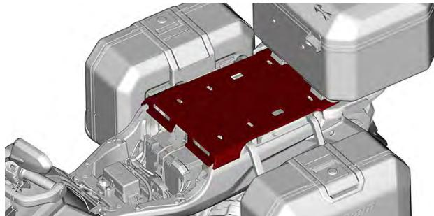
La piastra di supporto multifunzione si trova dietro il sedile del conducente.
