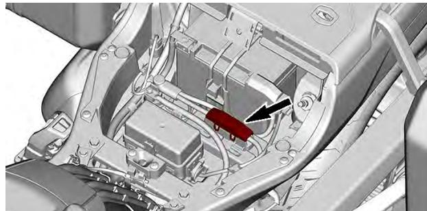
Per verificare se il fusibile è bruciato, rimuovere il coperchio del portafusibile: se la sezione metallica tra i due terminali è fusa o rotta, il fusibile è bruciato.
