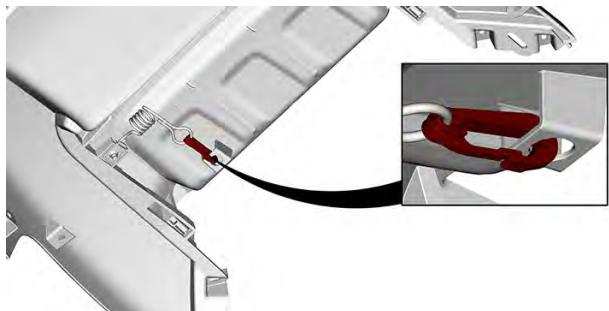
2. Installare il coperchio di manutenzione in posizione.
