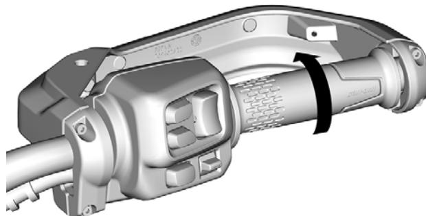
4. Premere l'interruttore di avvio del motore fino all'accensione del motore. Non premere il pulsante di avvio per più di 15 secondi. Se non si avvia, rilasciare il pulsante e attendere 30 prima di riprovare per consentire al motorino di avviamento di raffreddarsi.
