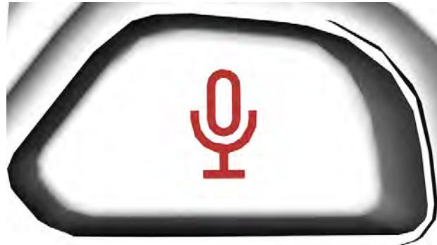
Serve per attivare l'assistente vocale del telefono. Per utilizzare questa funzione, il conducente deve disporre di un telefono e di una cuffia collegati tramite Bluetooth.
