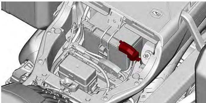
6. Iniziare collegando un'estremità del cavo con terminale ROSSO al terminale positivo (+) della batteria scarica.
