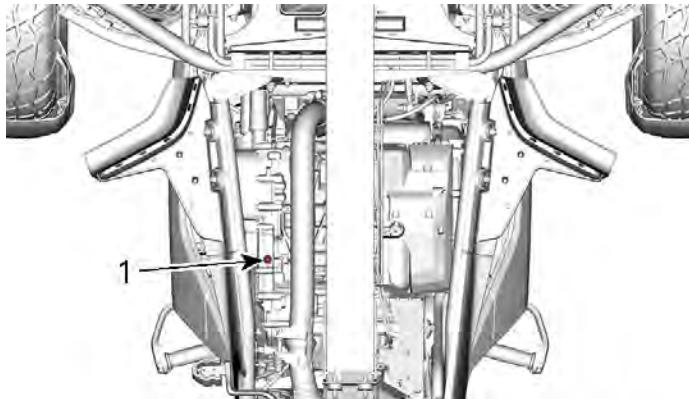
1. Tappo di scarico magnetico della copertura della frizione
