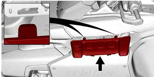
2. Spingere le linguette di fissaggio per assicurarsi che il coperchio sia correttamente bloccato in posizione.
