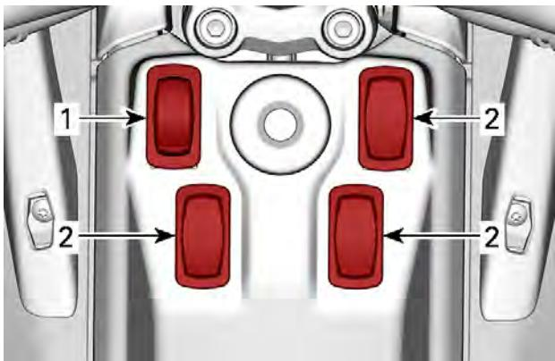
1. Interruttore delle manopole riscaldate del conducente (se in dotazione)
