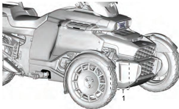
1. VIN impresso sul telaio
