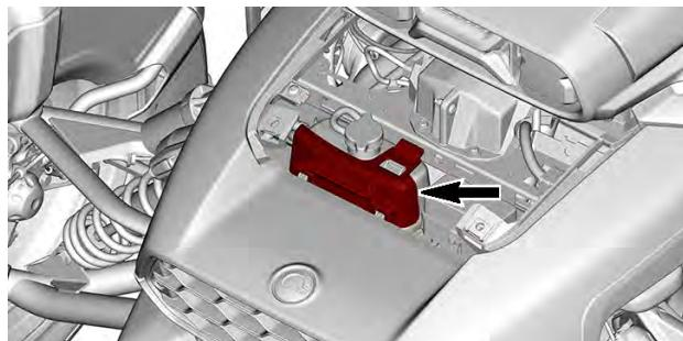
4. Controllare il livello di refrigerante nel serbatoio. Il liquido refrigerante deve essere visibile e il livello deve essere appena sopra la tacca COLD (livello minimo a freddo).
