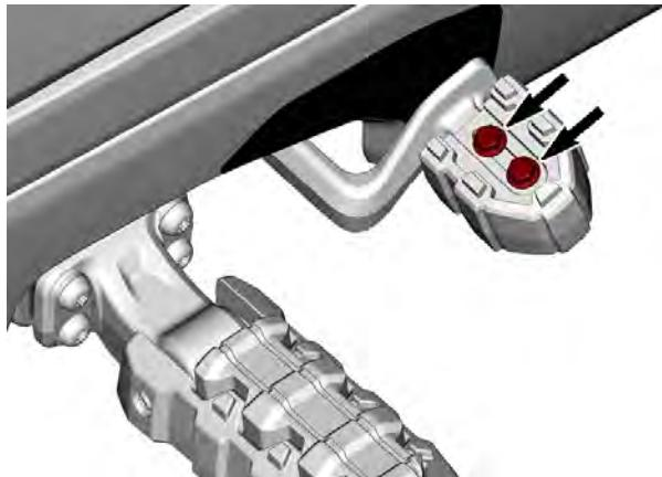
2. Spostare lateralmente il puntale del pedale del freno per regolare la posizione della larghezza.
