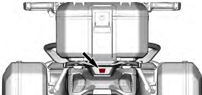
La telecamera è attiva automaticamente quando il motore è in funzione e si seleziona RETROMARCIA.
