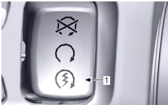
*1. Posizione di avviamento del motore*
