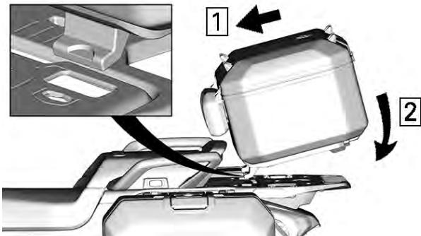
2. Assicurarsi che la linguetta di blocco posteriore sia inserita correttamente nella piastra di carico posteriore.
