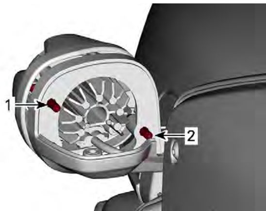
1. Pystysuuntaisen valokeilan säätäminen
