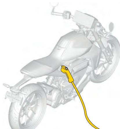
Tyypillinen – kuvassa tyypin 1 latauskaapelin liitin (SAE J1772)
