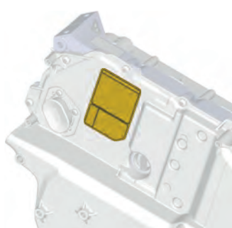
Batería de alto voltaje
