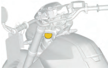
Depósito del refrigerante
