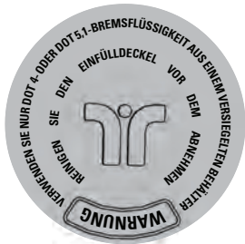
Bremsflüssigkeit für Hinterradbremse
