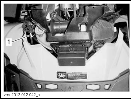
1. Réservoir de liquide de refroidissement
