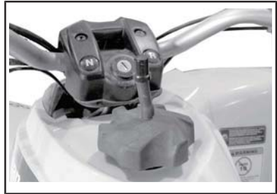
TÍPICA — TAMPA DO TANQUE DE COMBUSTÍVEL
