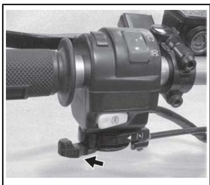
DISPOSITIVO ARIA IN POSIZIONE FULL
