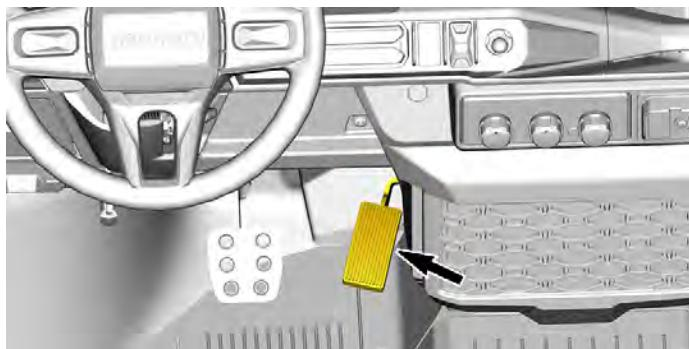
El pedal del acelerador controla la velocidad y la aceleración del vehículo.
