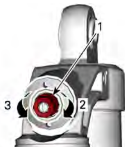
KOMPRESSIÖNSDÄMPNING FÖR HÖG HASTIGHET (ANVÄND EN 17-MM-NYCKEL)
