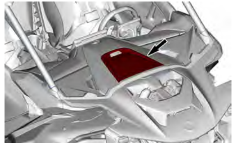
DEKSEL PÅ SIKRINGSBOKS FORAN
