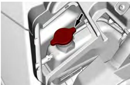
2. Aggiungere liquido di raffreddamento quando il livello del liquido raggiunge il riferimento MAX sul serbatoio del refrigerante. Fare riferimento a *Liquido refrigerante motore consigliato*. Usare un imbuto per impedire le perdite di liquido. **Non riempire eccessivamente.**
