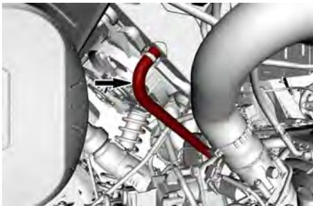
**TUBO FLESSIBILE SUPERIORE DEL RADIASTORE – VANO RUOTA POSTERIORE DESTRO**
