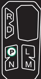
Prima di uscire dal veicolo, selezionare la modalità STAZIONAMENTO (P). In caso contrario, il veicolo potrebbe spostarsi. Per attivare la modalità di stazionamento, azionare il freno e premere il pulsante (P).
