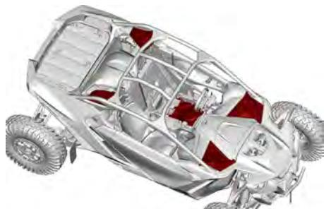
Il sistema audio è costituito da quattro altoparlanti e un involucro del subwoofer.
