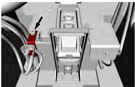
2. Rimuovere le due viti a testa esagonale e le rondelle piatte che fissano il supporto batteria al fondo del vano della batteria.
