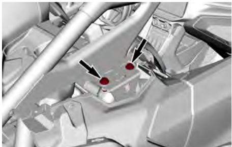
**DISPOSITIVI DI FISSAGGIO POSTERIORI – CONFIGURAZIONE TIPICA**
