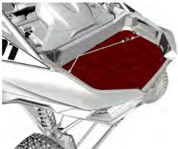
Consultare sempre l'*Etichetta della capacità di carico del veicolo* e l'*Etichetta di avvertenza sul caricamento* per informazioni sul caricamento e la capacità di carico.
