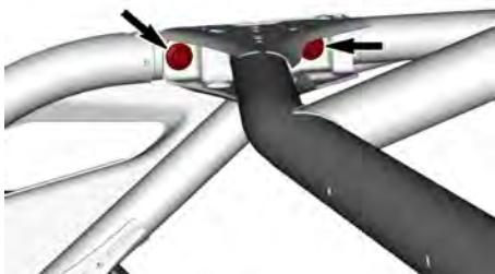
**DISPOSITIVI DI FISSAGGIO LATERALI POSTERIORI – CONFIGURAZIONE TIPICA**
