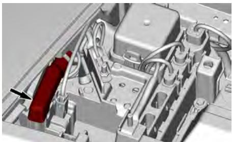
4. Iniziare collegando un'estremità del cavo con terminale ROSSO al terminale positivo (+) della batteria scarica.
