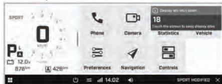
Il display touchscreen si terrà acceso per un'ora dopo l'ultima interazione con il touchscreen o finché il livello della batteria non scenderà a 11,8V.
