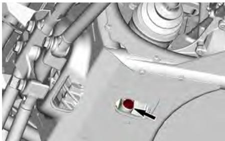
5. Posizionare una vaschetta di raccolta sotto la zona del tappo di scarico magnetico.
