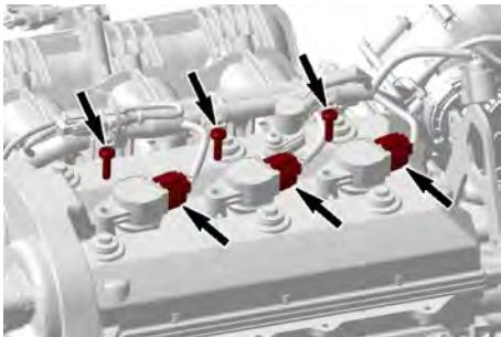
3. Rimuovere le bobine di accensione con guarnizioni dalla candela ruotando la bobina a destra e a sinistra estraendola.
