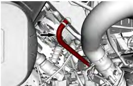
**TUBO FLESSIBILE SUPERIORE DEL RADIASTORE – VANO RUOTA POSTERIORE DESTRO**
