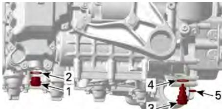
1. Tappo di scarico magnetico della copertura del serbatoio dell'olio
