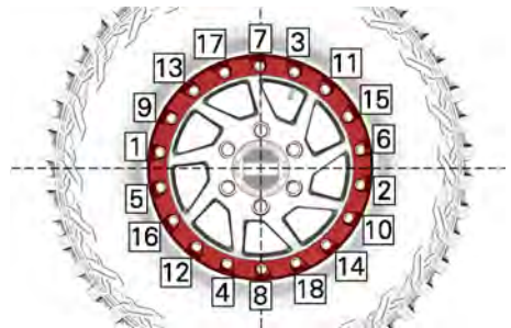
TYYPILLINEN KIRISTYSJÄRJESTYS
