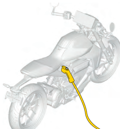
Típico – Conector do cabo de carregamento mostrado Tipo 1
