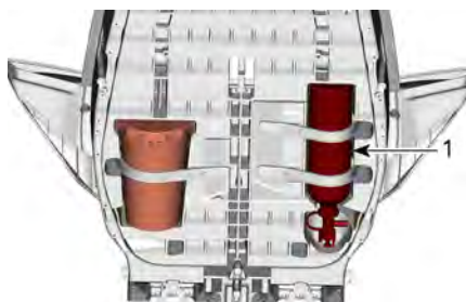
1. Extintor de incêndio
