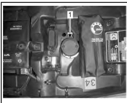
1. Depósito de líquido de los frenos traseros
