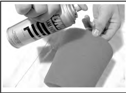
TÍPICO - LUBRIQUE EL FILTRO DE ESPUMA.
