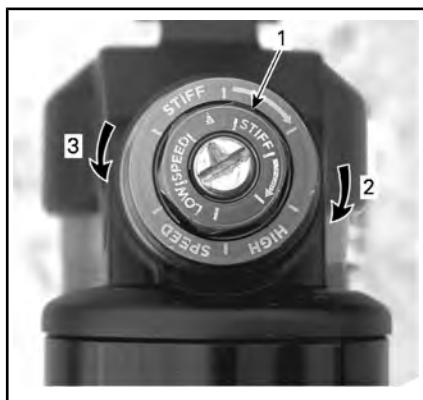
1. Ajustador del rebote (con destornillador plano)
