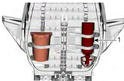
1. Extintor de incendios
