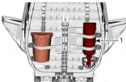
1. Extintor de incêndio
