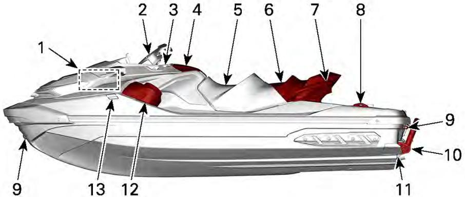
1. Vorderes Staufach (enthält die Halterungen für Feuerlöscher und Sicherheits-Kit)
