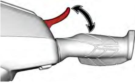
Der Gashebel ist federbelastet und sollte im unbetätigten Zustand in die Ausgangsposition (Leerlauf) zurückkehren.
