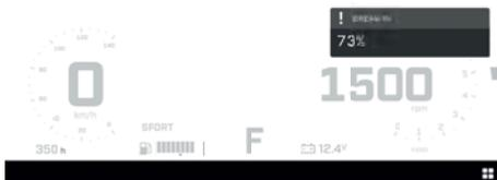
Durante le prime 3 ore di funzionamento, il sistema di gestione del motore limita la coppia del motore per la protezione del motore stesso. Le
