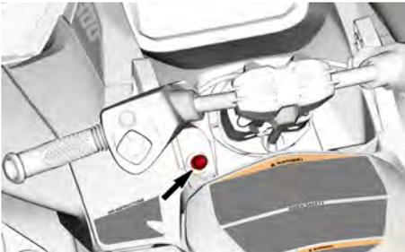
Per consentire al motore di avviarsi, il cappuccio del cordoncino di sicurezza deve essere saldamente fissato all'interruttore di spegnimento del motore.
