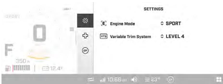
**NOTA:** Cambiare la posizione di assetto VTS senza che il motore sia in funzione con la marcia in avanti cambierà solamente l'indicazione. L'iniettore si sposterà alla posizione di assetto VTS selezionata una volta che verrà azionata la marcia in avanti.
