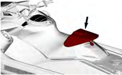
Questa sella fornisce un supporto tale che le cosce del conducente siano correttamente inserite nell'Ergolock, il che ha l'effetto di aumentarne l'efficienza e permette al conducente di resistere una maggiore accelerazione laterale trasferendo la forza al bacino piuttosto che alla parte superiore del corpo.
