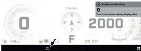
Il display touchscreen si terrà acceso per un'ora dopo l'ultima interazione con il touchscreen o finché il livello della batteria non scenderà al di sotto di 12,3 V.
