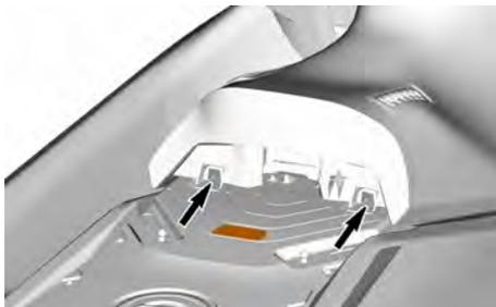
5. Allineare i fermi dell'estremità posteriore del sedile con i perni di aggancio e premere saldamente verso il basso l'estremità posteriore del sedile per bloccarla in posizione.
