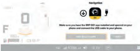
Se una o più mappe vengono scaricate direttamente sul display touchscreen a colori da 10,25", è possibile accedervi utilizzando l'opzione "Usa GPS integrato" senza collegare un telefono. Utilizzare l'opzione "Help" (Guida) per la risoluzione dei problemi.
