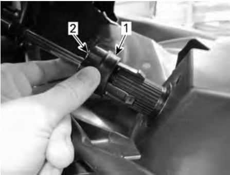
CABO DE DIREÇÃO DESENCAIXADO
