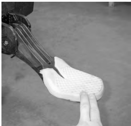
ESTRIBO MANTIDO ABAIXADO PARA EMBARCAR DA ÁGUA
