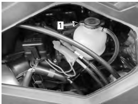
1. Tampa do tanque de expansão
