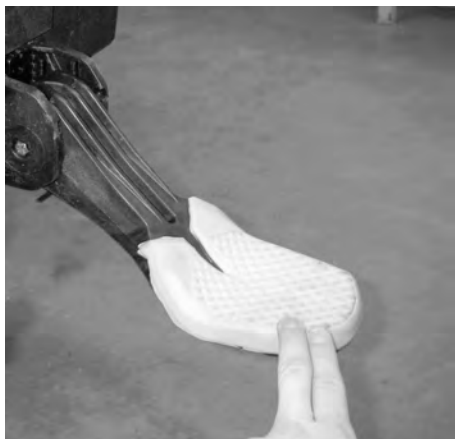
OPSTAPJE NEERGEKLAPT OM VANUIT HET WATER AAN BOORD TE STAPPEN
