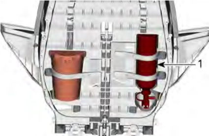
1. Extintor de incêndio
