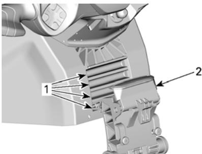
**TÍPICO: SEGURO DE AJUSTE DE LA COLUMNA DE LA DIRECCIÓN PUESTO**
