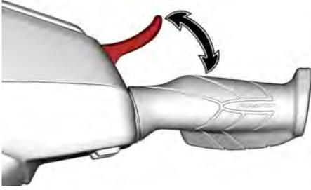
La palanca del acelerador está accionada por resorte y debería recuperar la posición de ralentí al dejar de presionarla.
