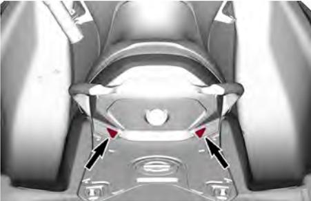
2. Seguidamente, tire del asidero del seguro hacia arriba y retire el asiento delantero de la embarcación.
