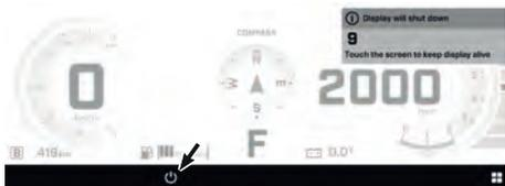
La pantalla táctil se mantiene ENCENDIDA durante una hora después de la última interacción con la pantalla táctil o hasta que el nivel de la batería caiga por debajo de 12,3 V.
