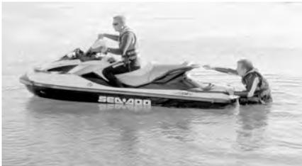
TÍPICO: ILUSTRACIÓN DE MODELO CON ESCALA DE EMBARQUE
