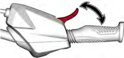
La palanca del acelerador está accionada por resorte y debería recuperar la posición de ralentí al dejar de presionarla.
