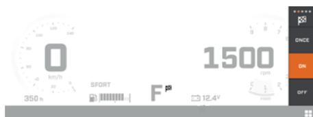
2. Utilice el botón del Navegador para seleccionar la función Modo Lanzamiento.
