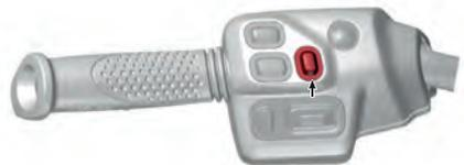
2. Pulse el botón de *Navegación arriba/abajo* para cambiar de modo.
