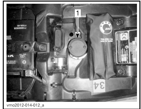
1. Réservoir de liquide de frein arrière
