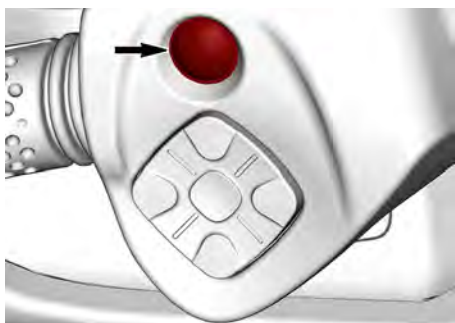
TIPICO – PULSANTE START/STOP MOTORE
