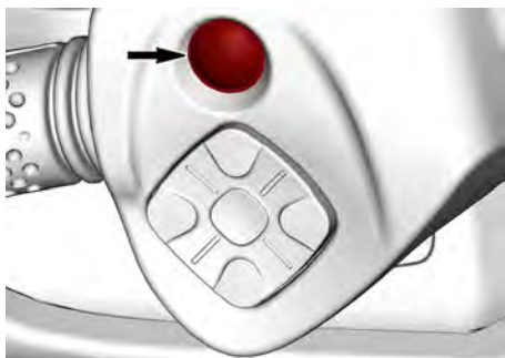
TYYPILLINEN – MOOTTORIN KÄYNNISTYS-/PYSÄYTYS-PAINIKE
