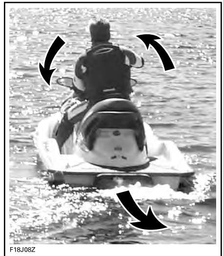
TYPBILD - STYRRIKTNINGEN OMKASTAD VID BACKNING
