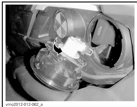
FAIRE TOURNER L'AMPOULE DANS LE SENS ANTIHORAIRE
