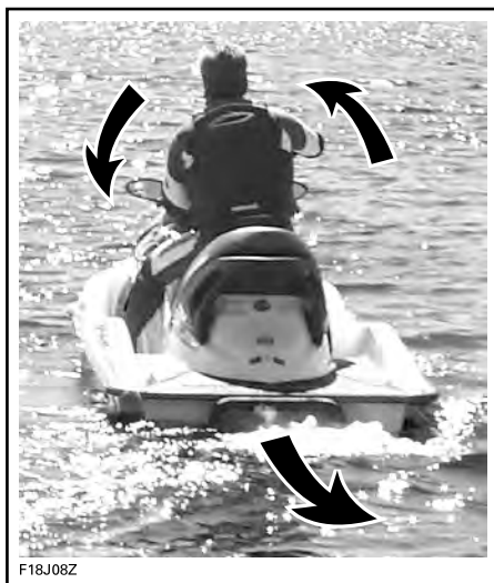
TYPBILD - STYRRIKTNINGEN OMKASTAD VID BACKNING
